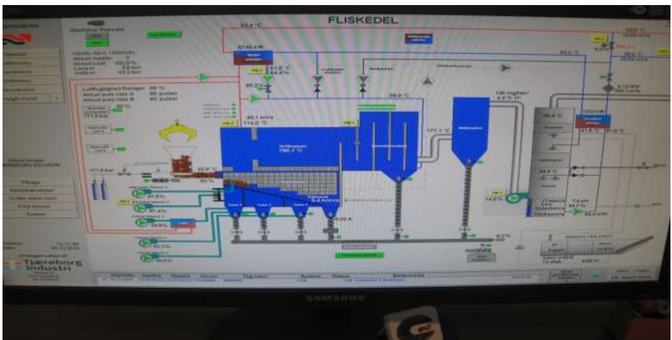
Given hakelämpölaitoksen kattila on Danstoker 5,6 MW
